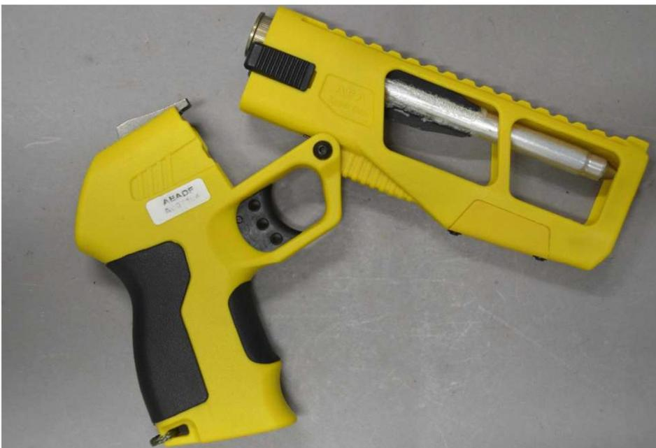
Abbildung 3: AEA „Spear Gun“, im aufgeklappten Zustand mit einer eingesetzten Abschussvorrichtung, Ansicht rechte Seite
